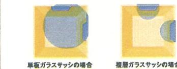
→ ガラス 空気 ガラス → 空気層が熱を遮断!
